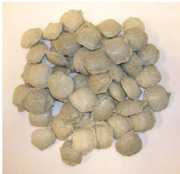
(b) 以擠壓方式產生之膨潤土粒狀回填材料(pellets)
