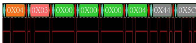
圖十六、系統對電表提出電壓之Query Message封包
