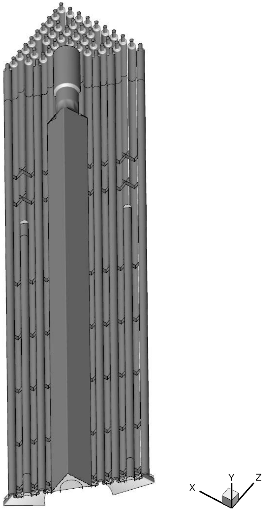
圖 21 整體 1/2 對稱 ATRIUM-10 燃料模型(X:Y:Z=1:0.2:1)
