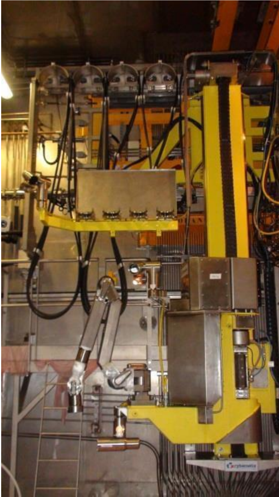
圖 2.14 使用 Maestro 臂進入輻射屏蔽區域吊掛移動物品 1
