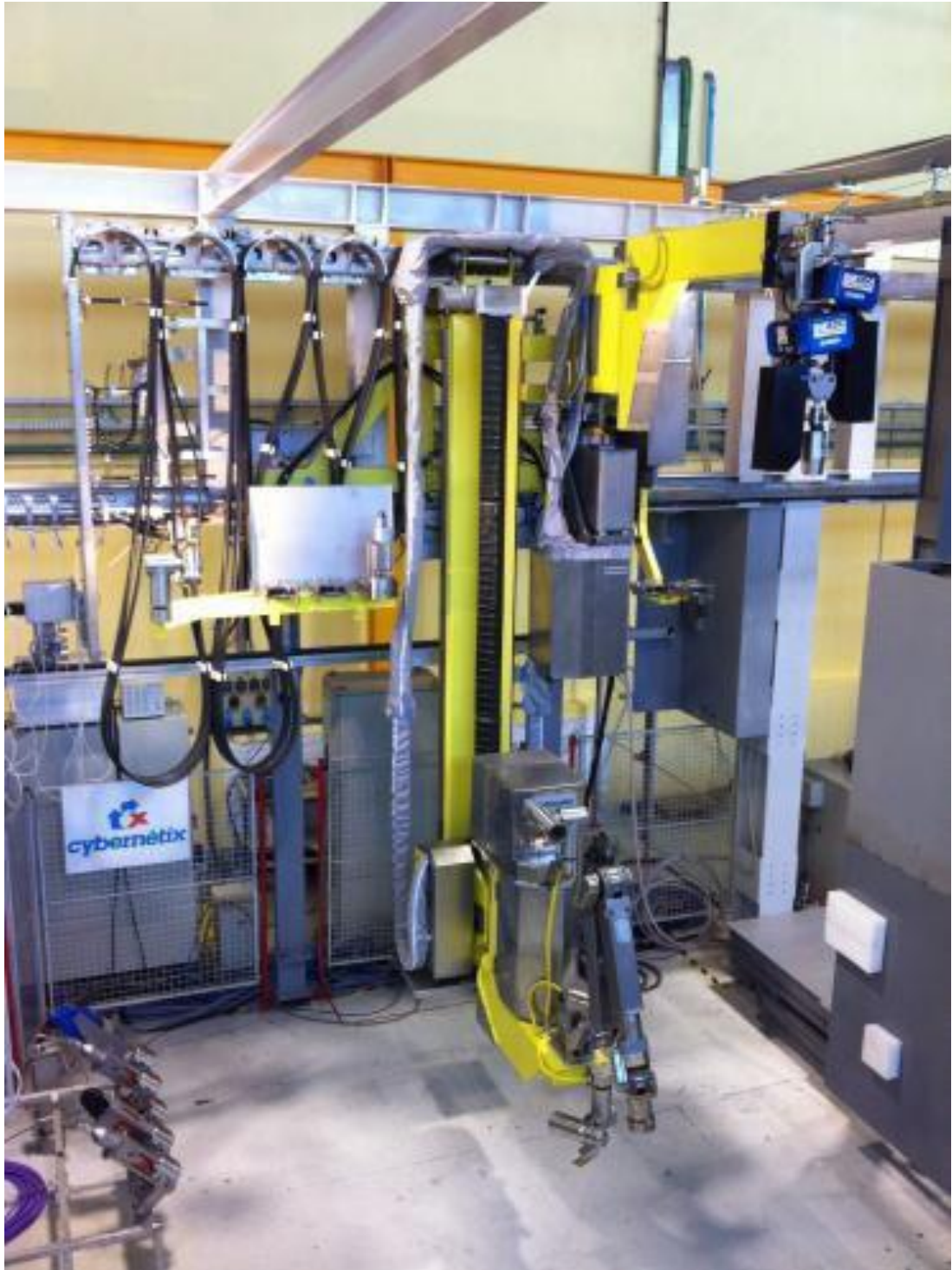
圖 2.9 遠程遙控技術 Maestro 臂實際構造組裝圖 1
