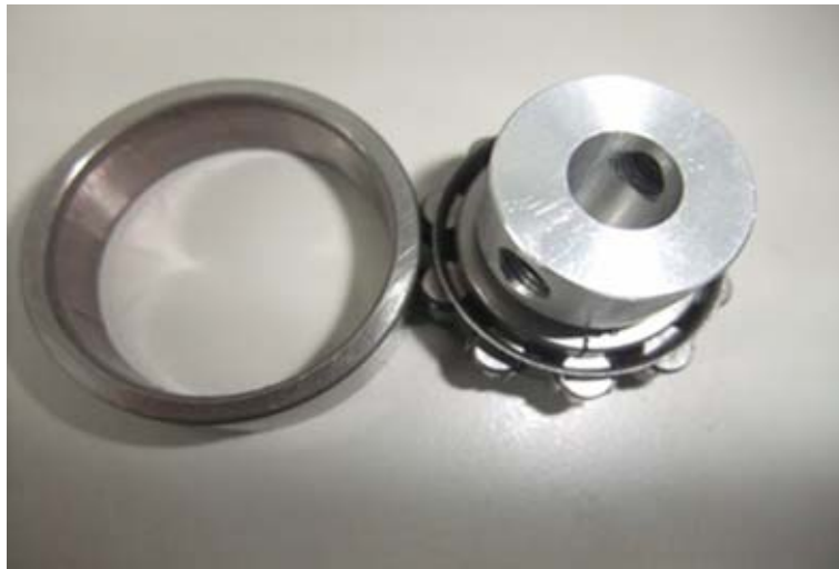
圖 2.23 N203 內圈損壞軸承
