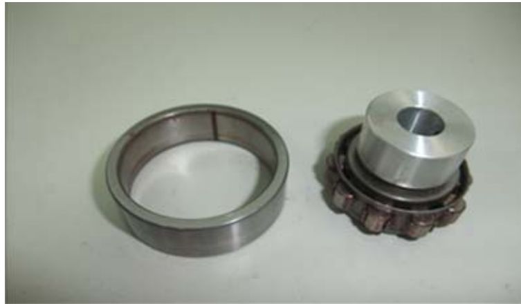
圖 2. 24 N203 外圈損壞軸承
