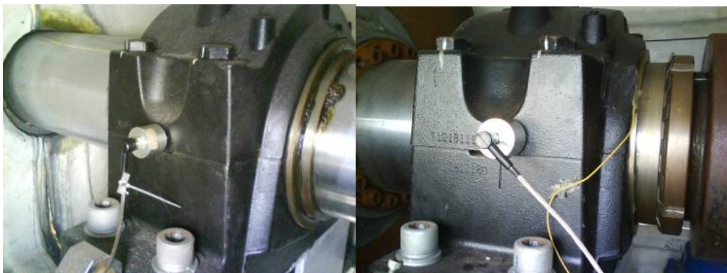
圖 1.2 驅動端與非驅動端軸承裝置之加速規
