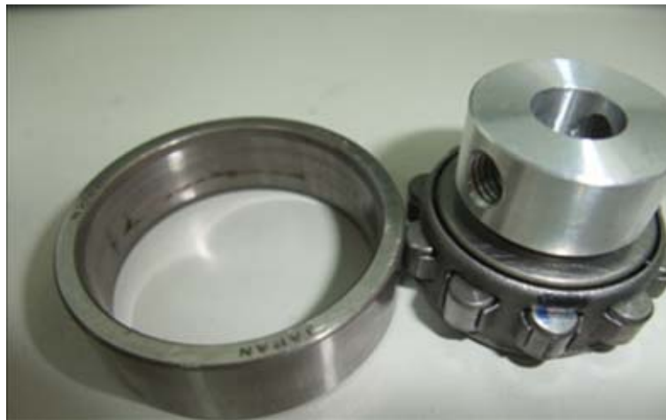
圖 2. 25 N203 滾柱損壞軸承
