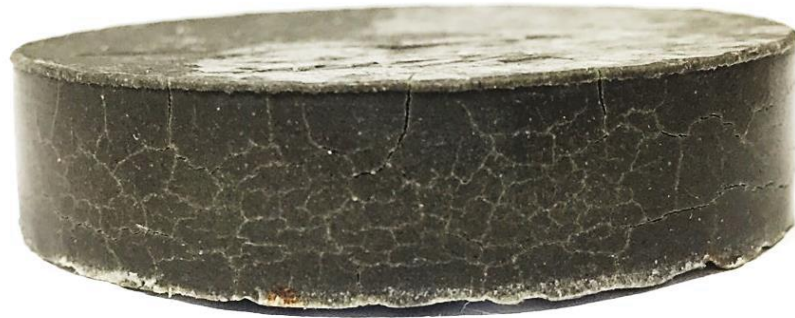
圖 3.12 65°C 水-熱環境後之外觀 (側面產生裂縫)
