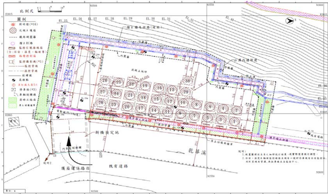
圖 3、核一廠乾貯場址配置與場界圖面[1]
