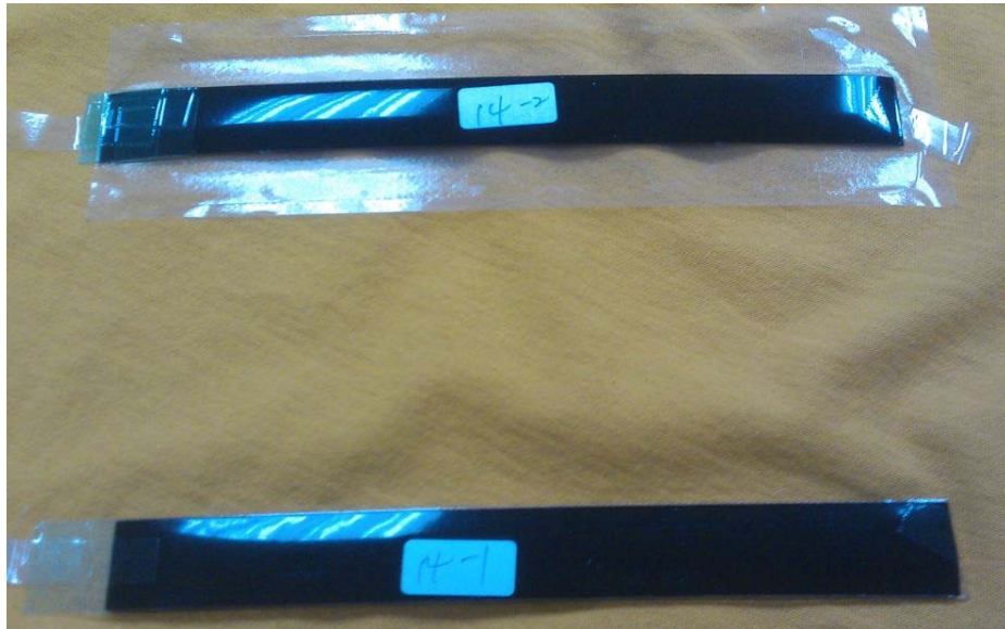
圖七、試件(溫度155 °C、壓力80 Kpa)
