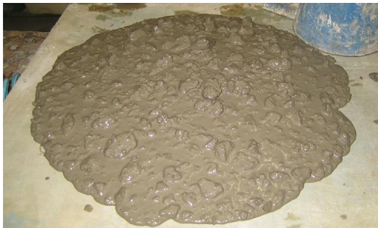
圖 2.7 雙系統配比現場坍流度[22]
