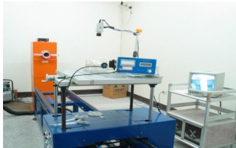
圖 3. 清華大學原科中心之二級標準輻射偵檢儀校正場(使用 ^{137}\text{Cs} 輻射源)
