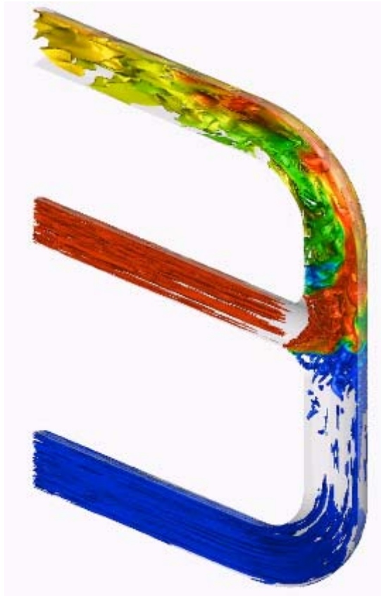
圖 3-24、混合三通管在暫態狀態下的內部流動情形
