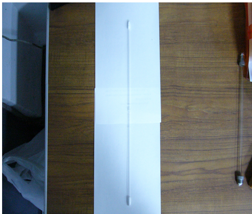
Figure 4.1-6 反應管 C。長：40 cm；管徑：1/8 in。
