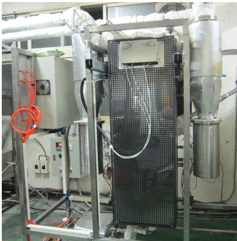
圖 2.3 20 kWth 內通式流體化床氣化熱模系統整體外觀圖
