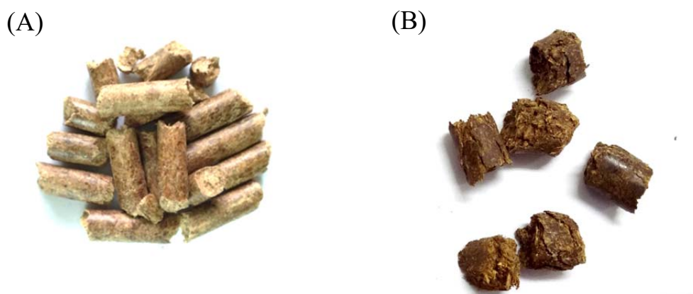
圖 2.1 生質物原料(A) 雜木顆粒；(B) 廢棄菇包培養土顆粒
