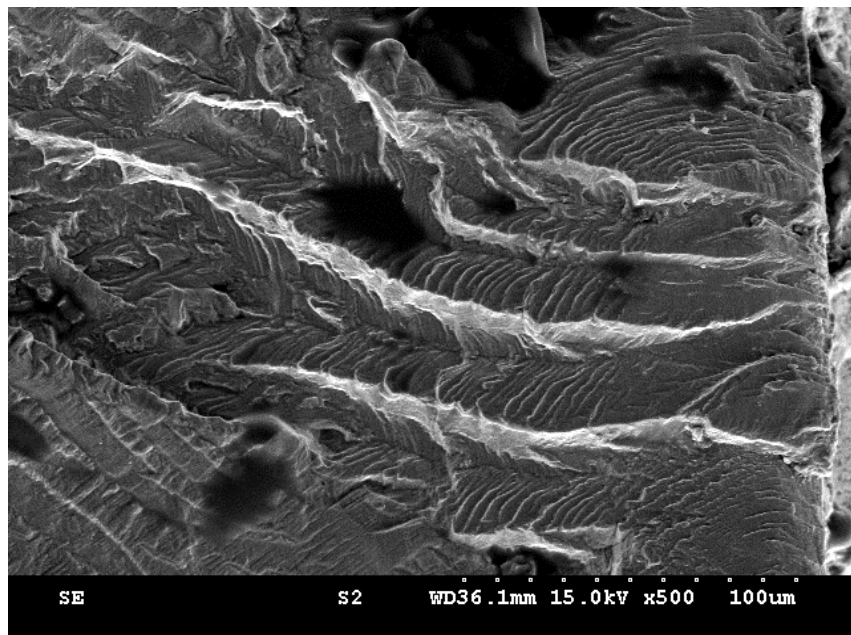
圖 3-18 變動振幅疲勞裂縫起始區
