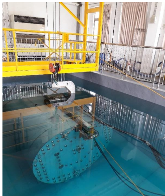
圖 27 水下圓盤鋸切割測試作業
