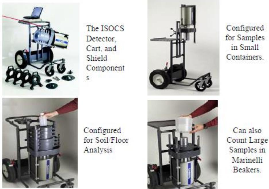
圖 5-8 CANBERRA ISOCS 系統
