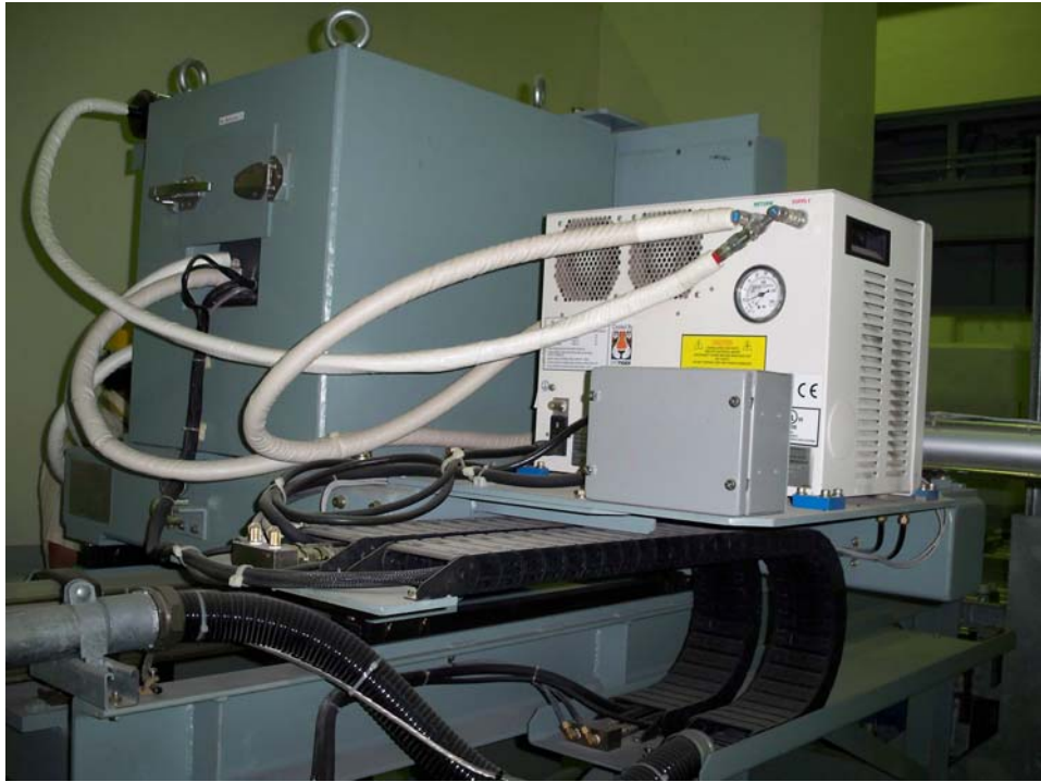
圖 10、WDIS 廢棄物桶加馬核種活度量測單元
