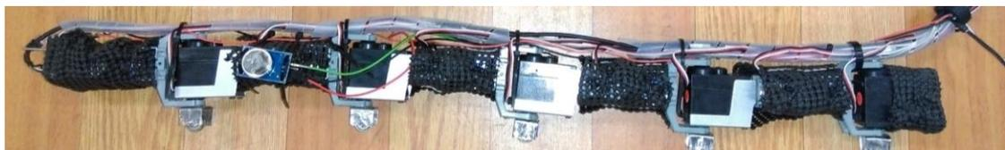
圖 3.6：並連式之機器蛇連接電路[2]
