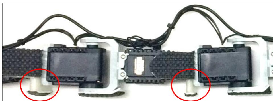
圖 2.17：裝設平衡支柱
