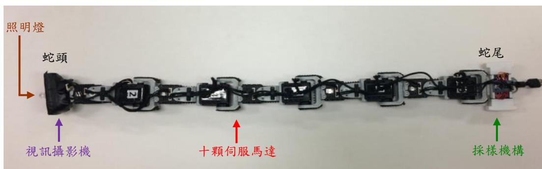
圖 2.4：機器蛇端之整體機構設計圖
