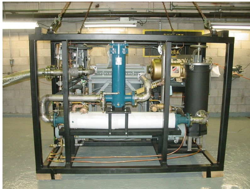
圖 2、Holtec 公司所設計之強制氦氣乾燥機[7]
