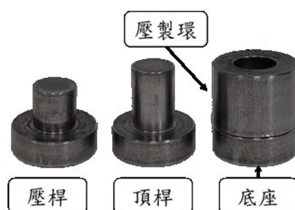
圖 3-18 水汽平衡法試驗室體壓製模具
