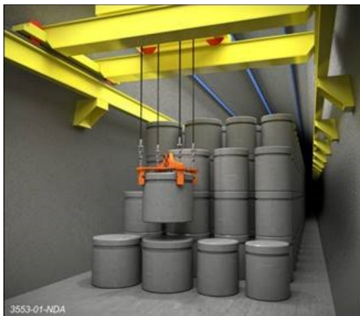
圖 3-30 堆放在低強度沉積岩的專用處置窖內的 1 立方公尺混凝土桶和 500 公升混凝土桶
