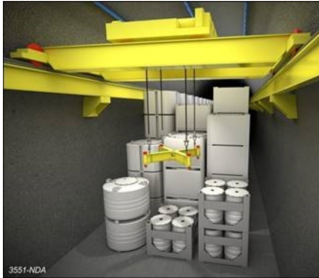
圖 3-21 UILW 容體剖面示意圖－低強度沉積岩
