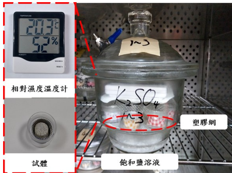
圖 3-23 水汽平衡法配置系統
