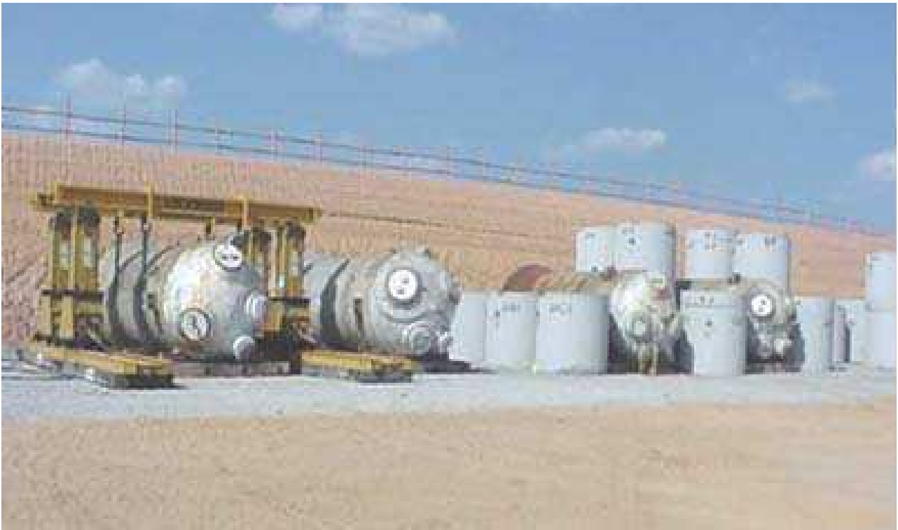
圖 3.16 移動蒸汽產生器下部組件到乾式貯存設施
