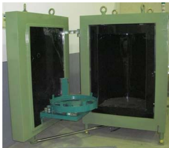
圖 6、INER-SWAM2 塑膠閃爍體偵檢器量測系統
