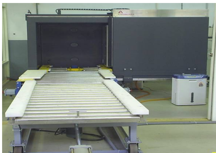
圖 7、Canberra/Q2 純鍺偵檢器組合量測系統
