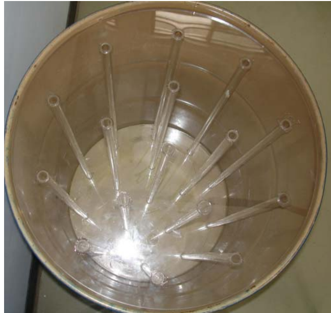
圖 11、桶型 16 支棒水溶液體射源
