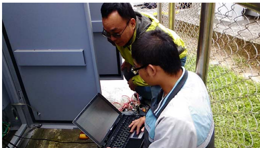
圖 3.27 雙電源相序現場測試圖(三)
