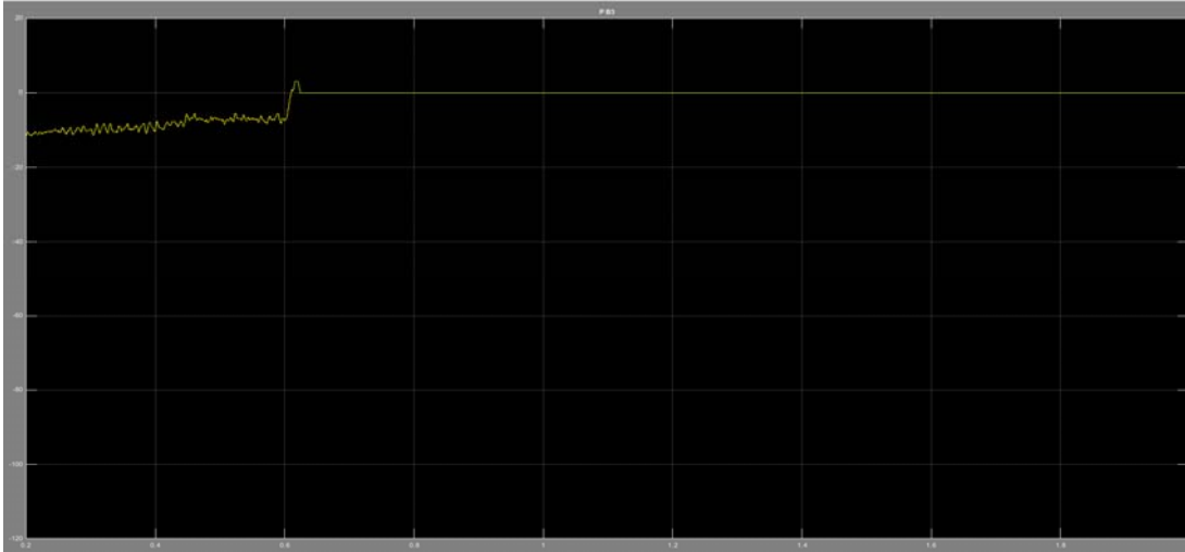
圖3.43 情境二微電網由台電輸入實功率波形
