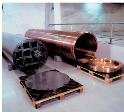
圖 2.4 芬蘭處置罐圖示[3]
