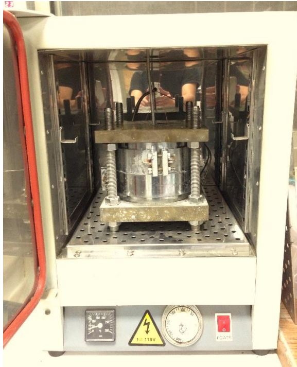
圖 3.3 試體加熱系統之配置圖
