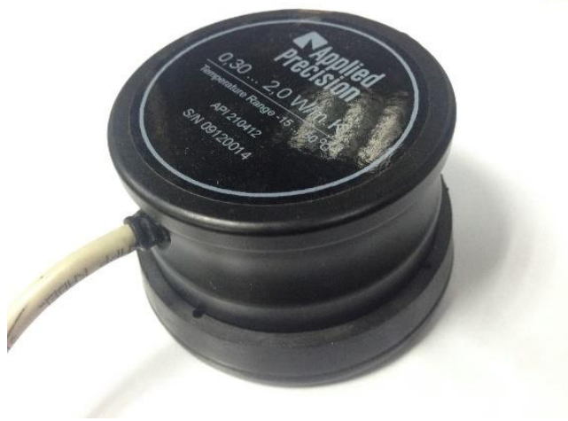
圖 3.15 表面接觸式探測計
