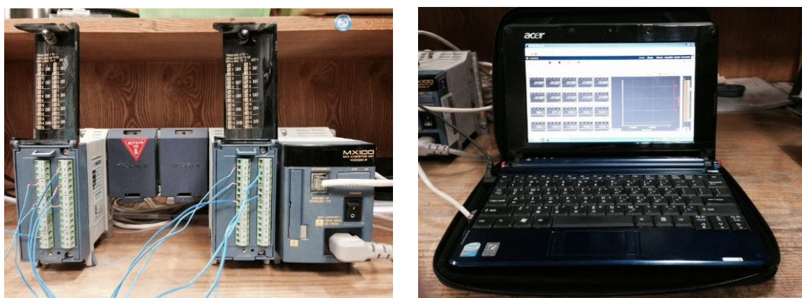
圖 3.5 MX100-02E 資料擷取系統(左)；程式操作介面(右)
