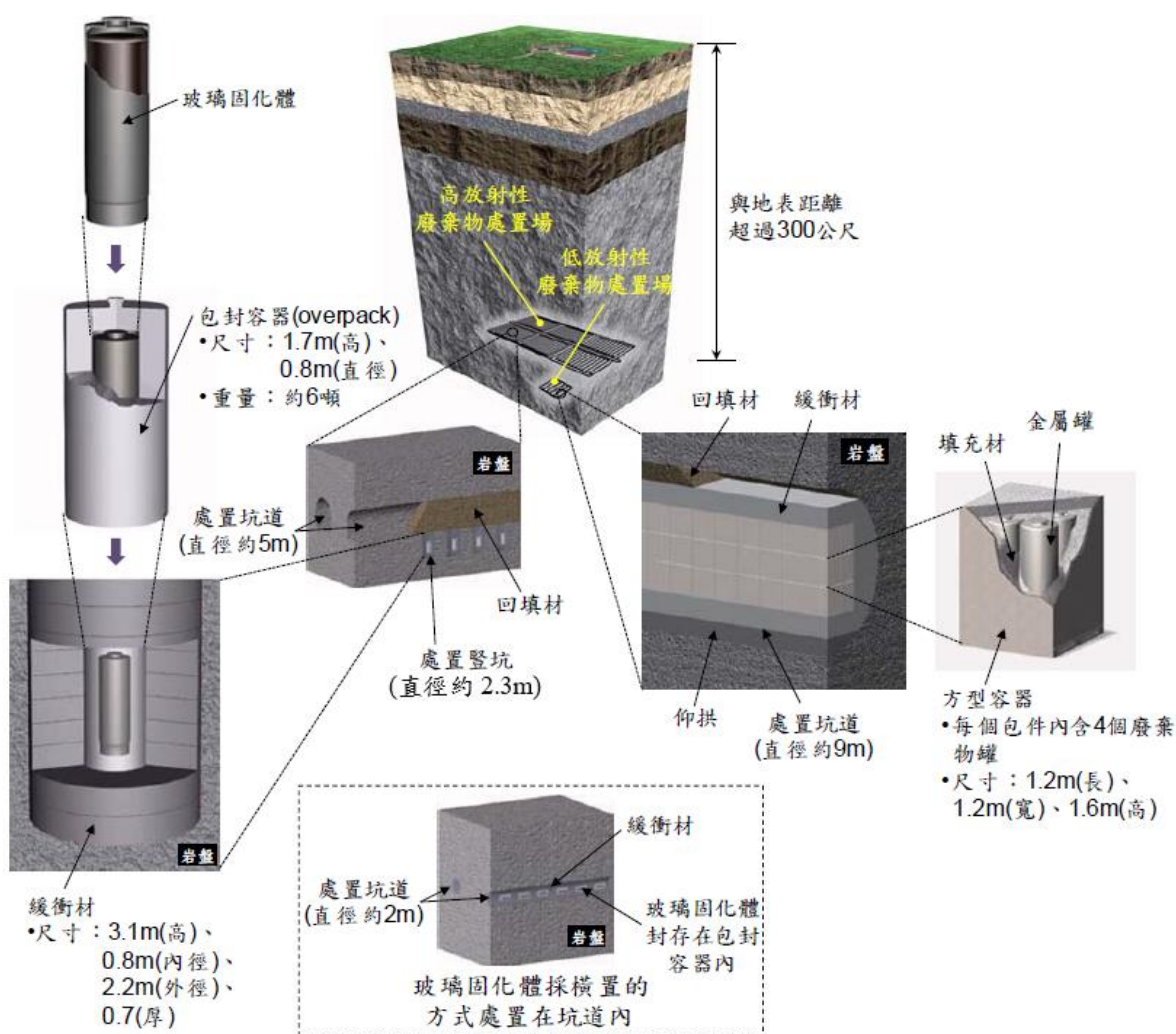
圖 2.1 日本深地層處置場多重障壁概念圖[1]
