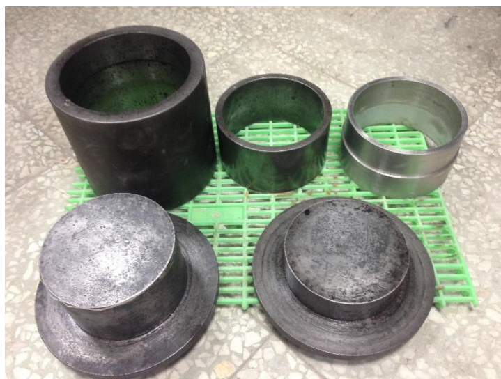
圖 3.17 攜帶式熱傳試驗模具
