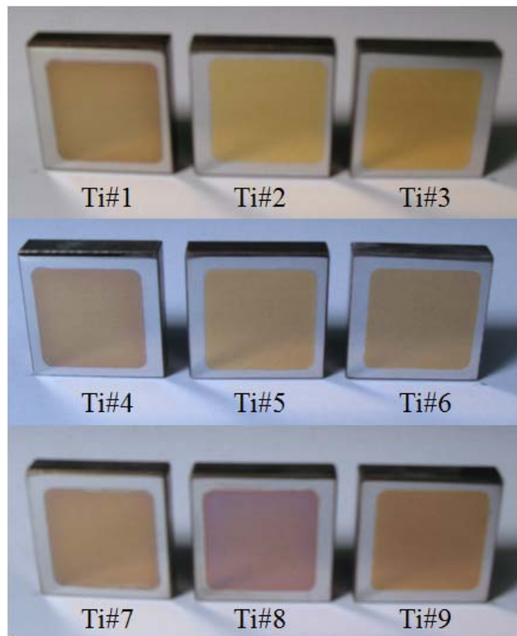
圖 3-6、Ti#試片初鍍膜。
