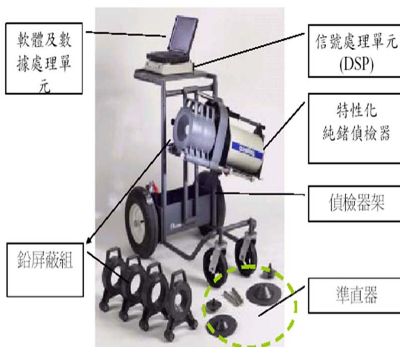
圖 10：Canberra-ISOCS 移動式加馬活度偵檢器
