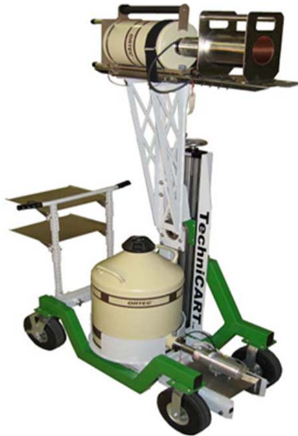
圖 7：ORTEC-ISO-CART 移動式純鍍偵檢器
