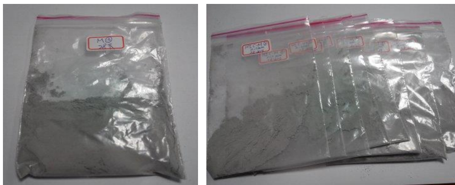
圖 3.8 研磨後的試體與其分層粉末
