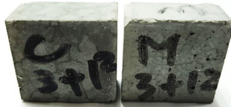
圖 4.5 經 12 小時 200°C 烘箱養護所產生之裂縫
