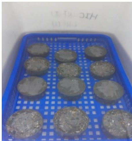
圖 3.6 混凝土浸泡 NaCl 溶液示意圖
