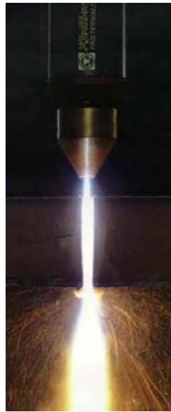
圖 3-5 電漿火炬切割鋼板
