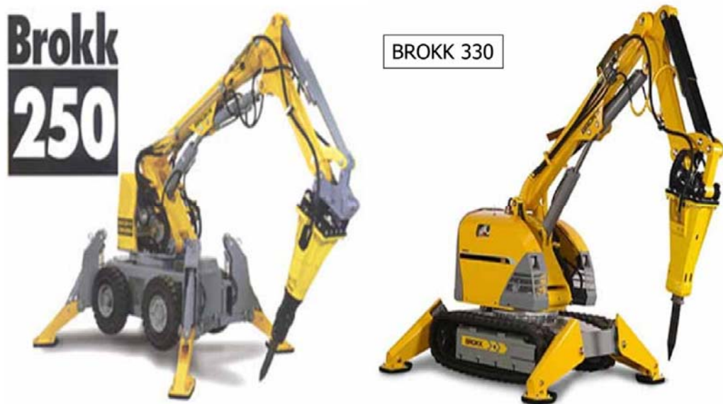
圖 3-25 遙控的反鏟式衝擊錘
