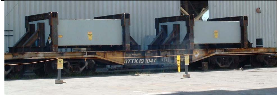
二個特製容器安裝固定在多軸台車運輸
