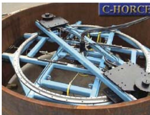
圖 4-21 環形液壓操作切割設備(CHORCE)概念圖
