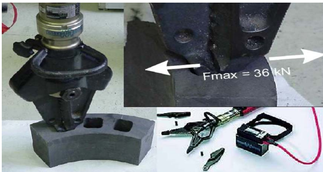
圖 3-14 油壓撐開器破壞石墨
