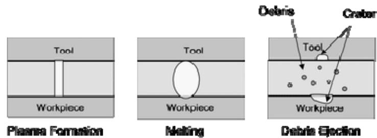
圖 3-8 放電加工去除材料示意圖
