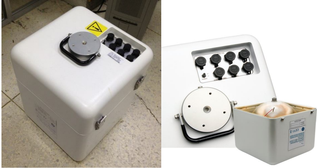
圖 6.5.1-4. 高壓游離腔的外觀與內部構造。
