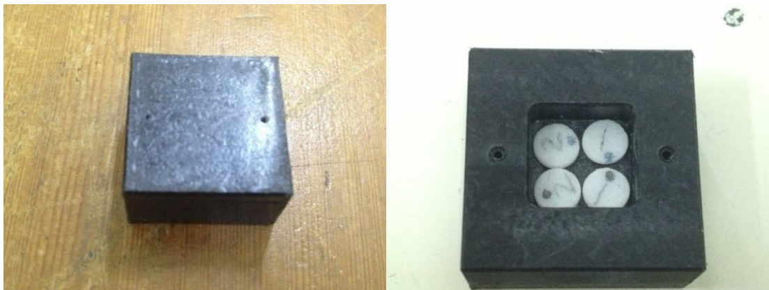
圖 6.5.1-6. 熱發光劑量計承裝盒與內部 4 片熱發光劑量計的實體圖。
