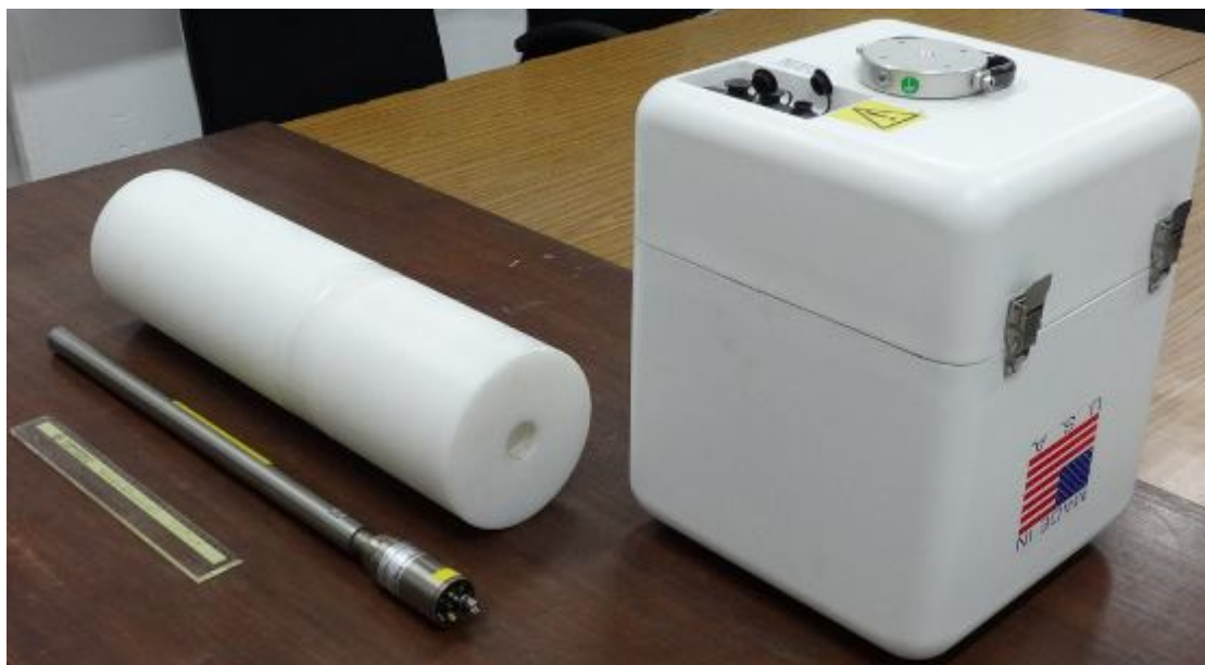
圖 6.5.1-1. 測量中子的 ^3\text{He} 比例計數器、中子緩速體與測量加馬射線的高壓游離腔。
