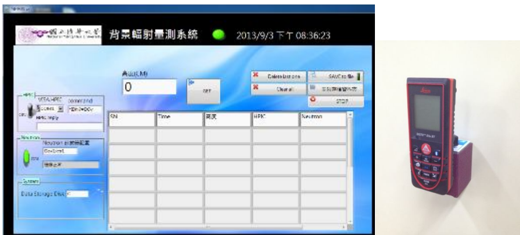
圖 6.5.2-1. 護箱表面劑量自動化資料擷取系統與雷射測距儀。
