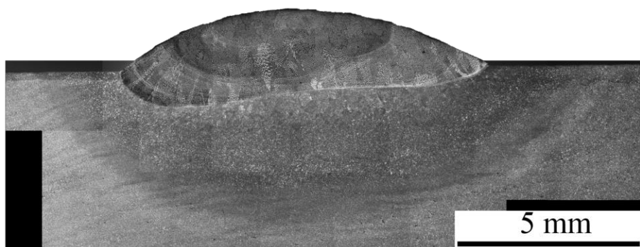
圖 3-2 (a) G-S-1、(b) G-S-2、(c) P-S-7 及(d) P-S-8 之覆鋅試片的巨觀金相圖。
