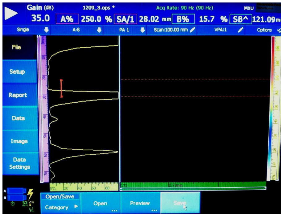
圖 B.2-10 2.25 MHz 在 Overlay 建全區之波形及距離量測。
