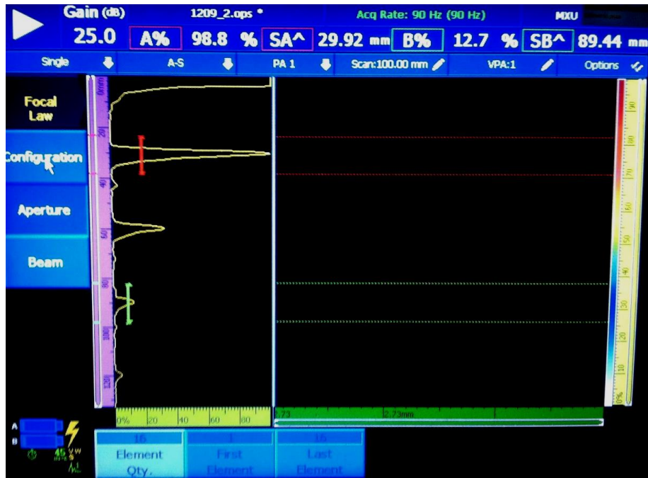
圖 B.2-7 2.25 MHz Overlay + Base Metal 衰減(1)。
