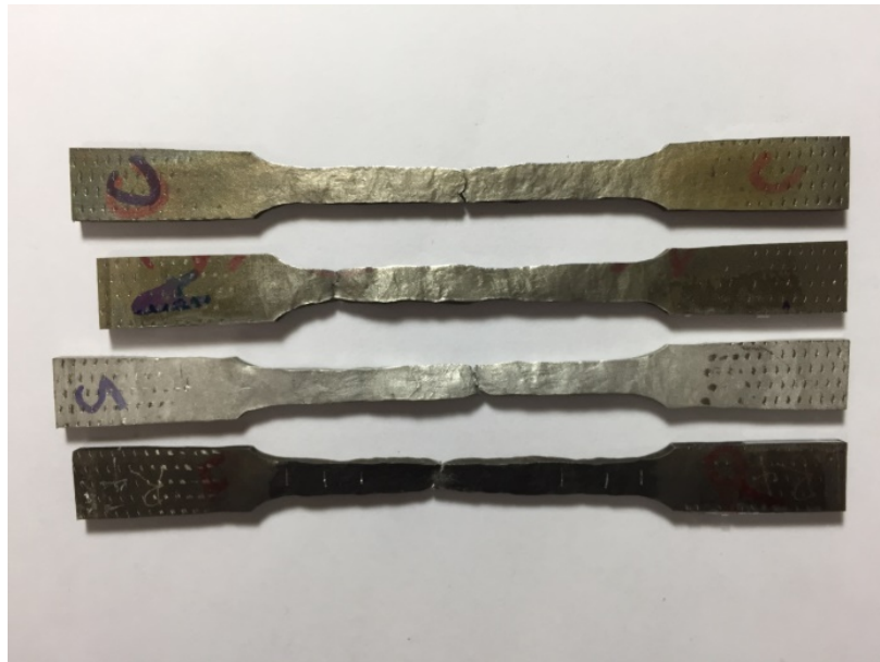
圖 7.拉伸試驗斷裂試件巨觀
