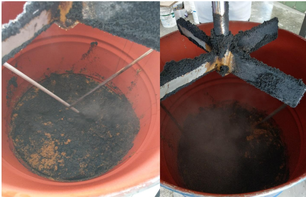
圖 3-10 模擬實場大型試驗固化體製作情形
