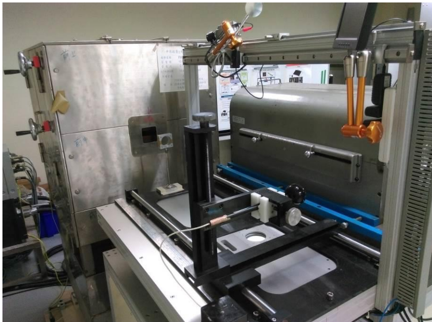
圖 4-6. 能力試驗新 X 光照射系統與半值層測試實驗設置圖
