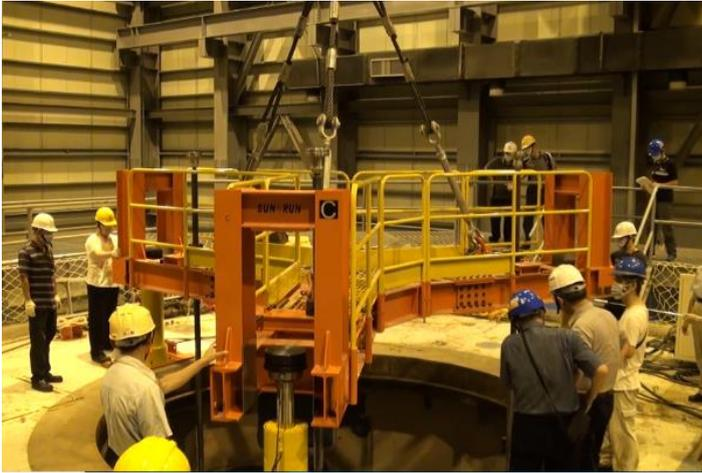
圖27 Y型鬆動機具測試作業
