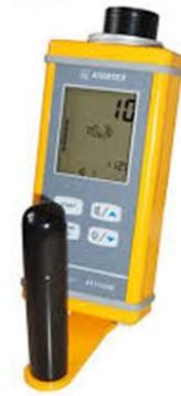
圖 3.1 手持式塑膠閃爍偵檢器 ATOMTEX AT1121(AT1123)(左)、
