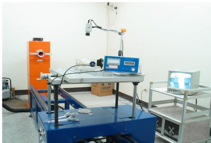
圖 3.3 清華大學原科中心之二級標準輻射偵檢儀校正場( $^{137}\text{Cs}$  輻射源)
