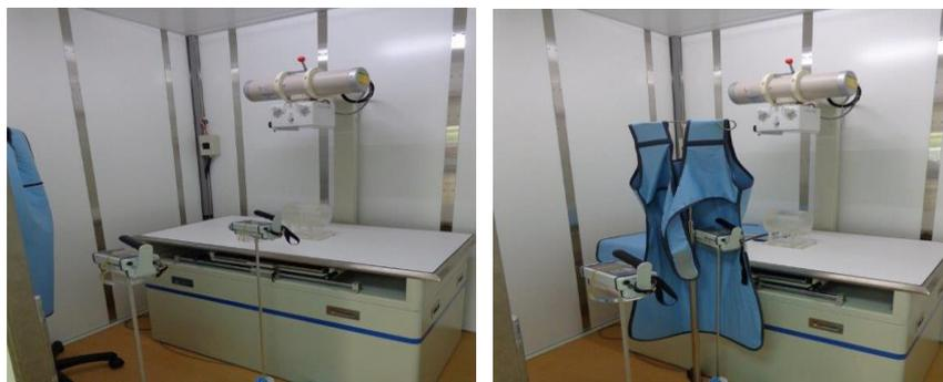
圖 3.8 考量動物用 X 光機協助者在檢查室內協助動物擺位照相的情形，以手持式偵檢器測量，評估其有穿(右)及無穿(左)鉛屏蔽衣之居佔位置劑量(率)示意圖
