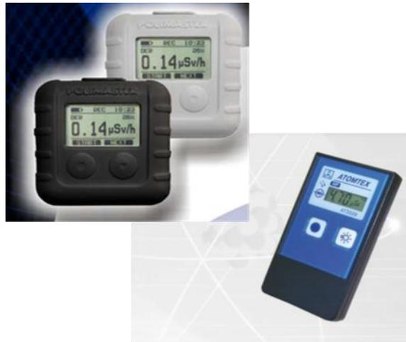
圖 3.2 可測累積劑量與劑量率之電子式劑量警報計
