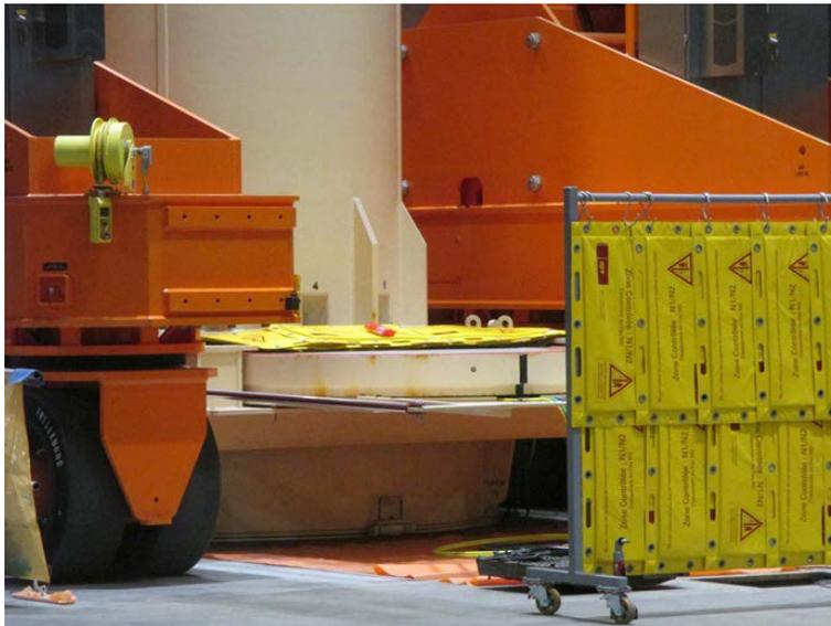
圖 3.10、鋼筒下載過程中使用的碳鋼圓環以及雙層鉛屏蔽[32]
