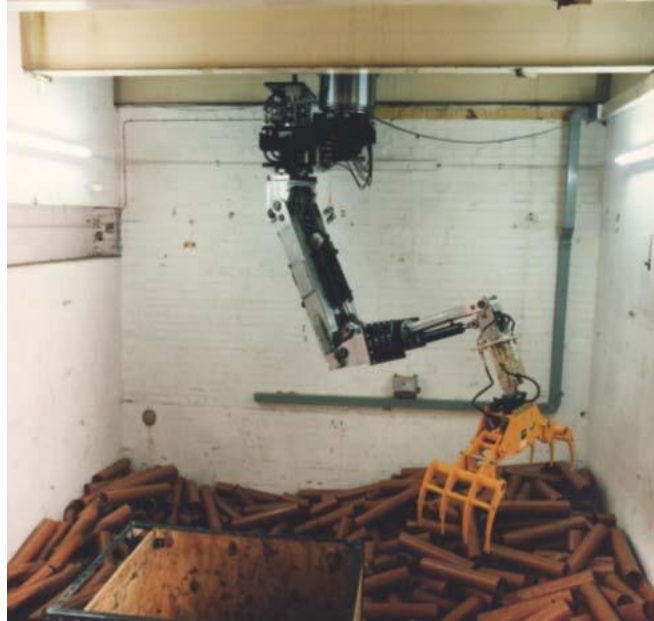
圖 47：RWE NUKEM 為輻射作業開發之機械手
