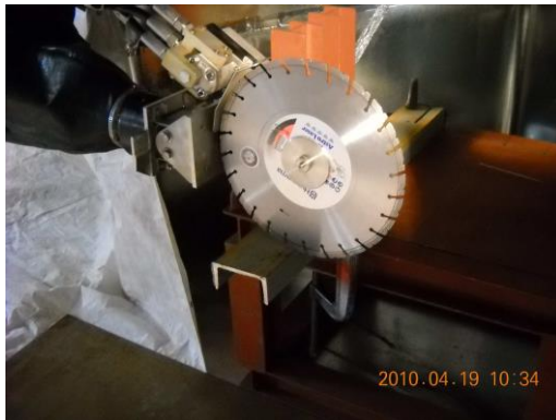
圖 24：鑽石圓盤鋸切削試驗(左)切削前(右)切削後(Tokai 1)
