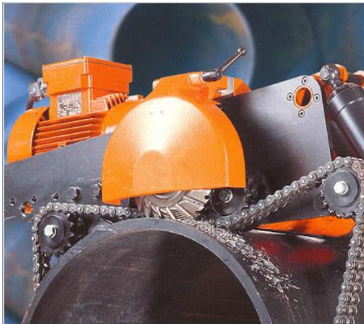
圖 39：銑削刀具沿鍊條切斷鋼管
