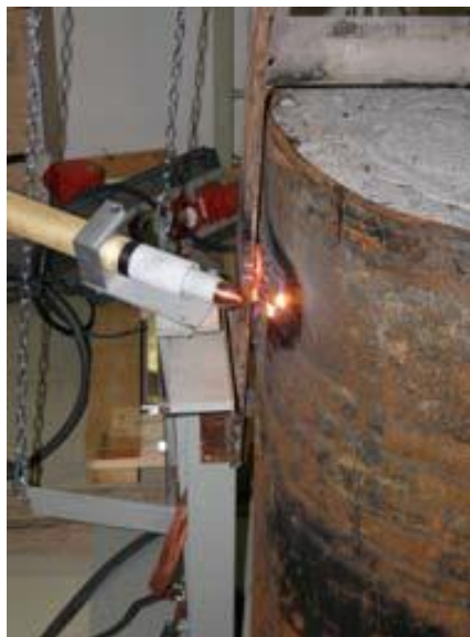
圖 7：電漿火炬切割鐵桶吊耳
