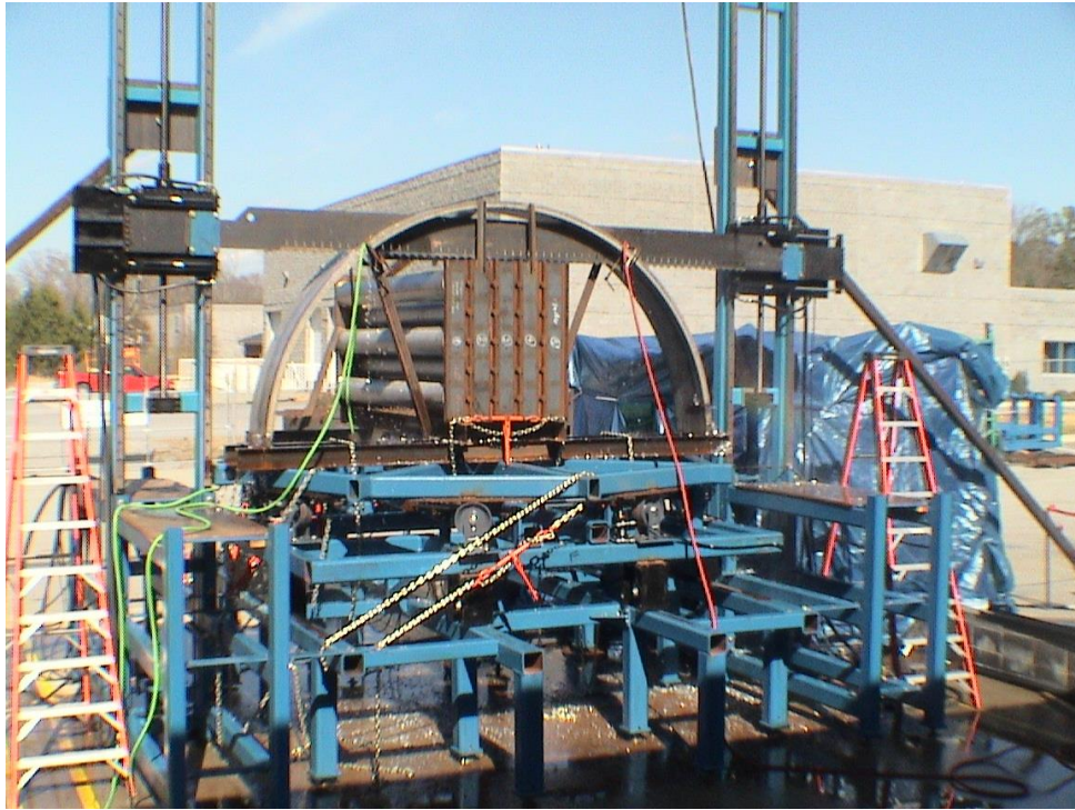
圖 29：開刀式往復鋸用於模擬測試(Rancho Seco)
