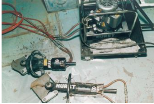
圖 16：攜帶型油壓剪
