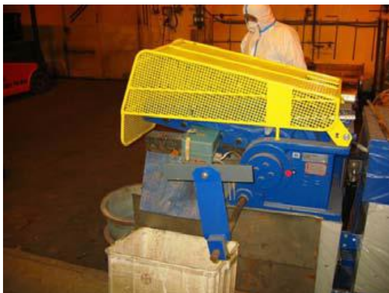
圖 15：固定式液壓剪切機
