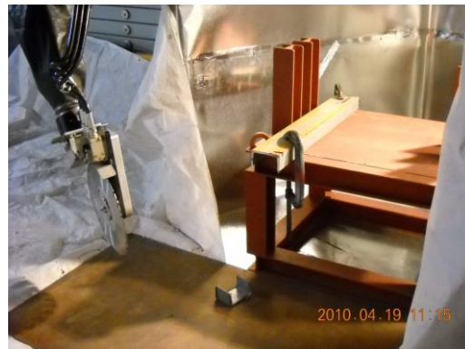
圖 24：鑽石圓盤鋸切削試驗(左)切削前(右)切削後(Tokai 1)
