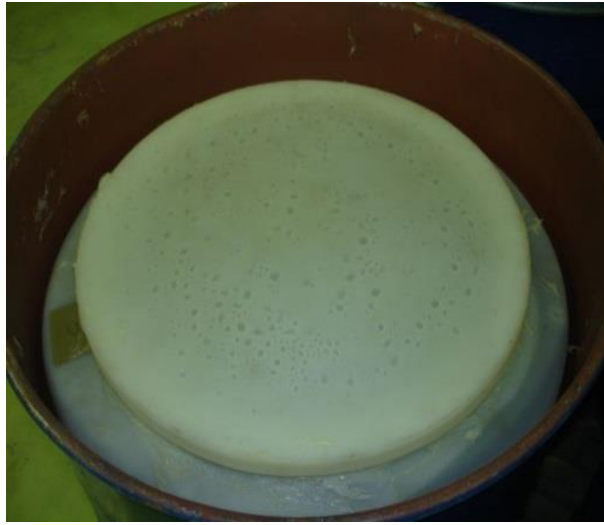
圖 8：整桶樹脂(充填率 96%)
