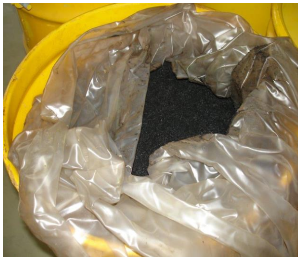
圖 9：整桶過濾器活性炭(充填率 90%)
