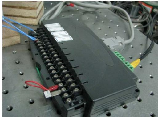
水化熱量測單元與受測試樣
