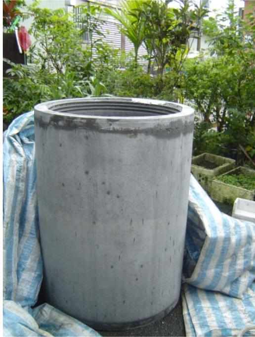
圖 2-27 高性能鋼纖維混凝土高完整性承裝容器
