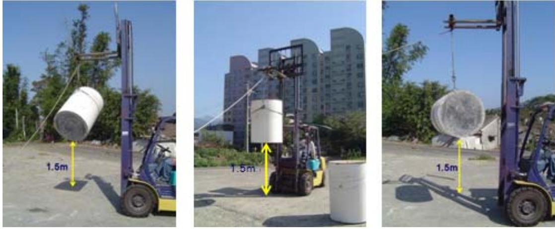
圖 2-29 高完整性承裝容器原型墜落測試
