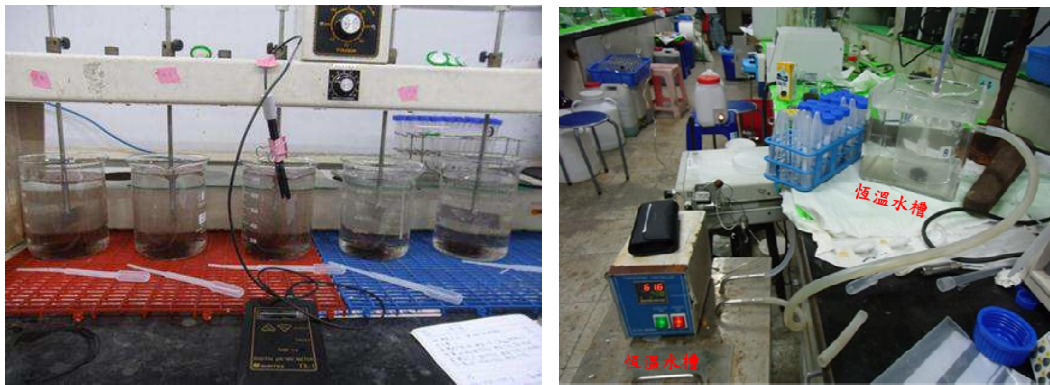
圖 2-2(a) Jar test 吸附反應裝置 (b) 不同溫度下的恆溫水槽裝置
