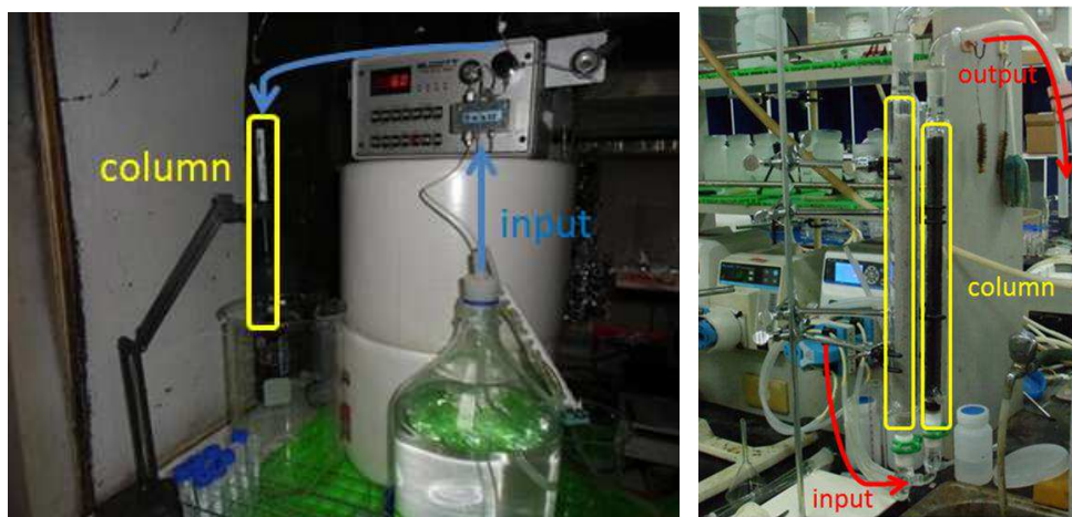
圖 2-4 (a) 使用 0.46x25 cm 管柱的連續流裝置 (b) 使用 2x40 cm 管柱的連續流裝置
