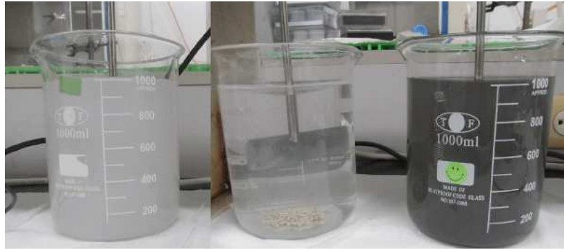
圖 3-3 吸附鋁實驗進行一天後，溶液的濁度改變，由左至右分別為 GT-Z w 、AC-5BZ 及 GT-Z B
