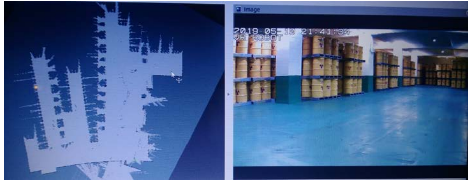
圖 3-10.原型機於輻射場域偵測任務之地圖建構圖
