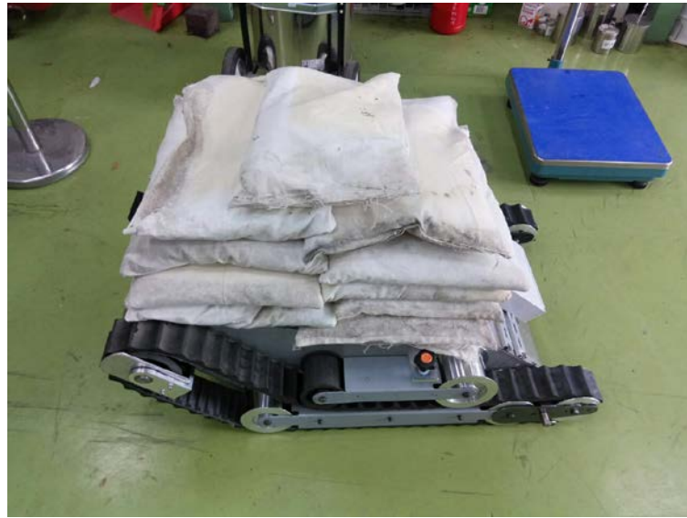
圖5-2 載台乘載沙袋實測照
