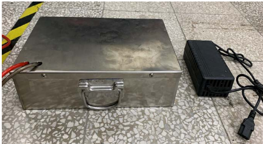
圖4-18 備用鋰電池及載台專用充電器
