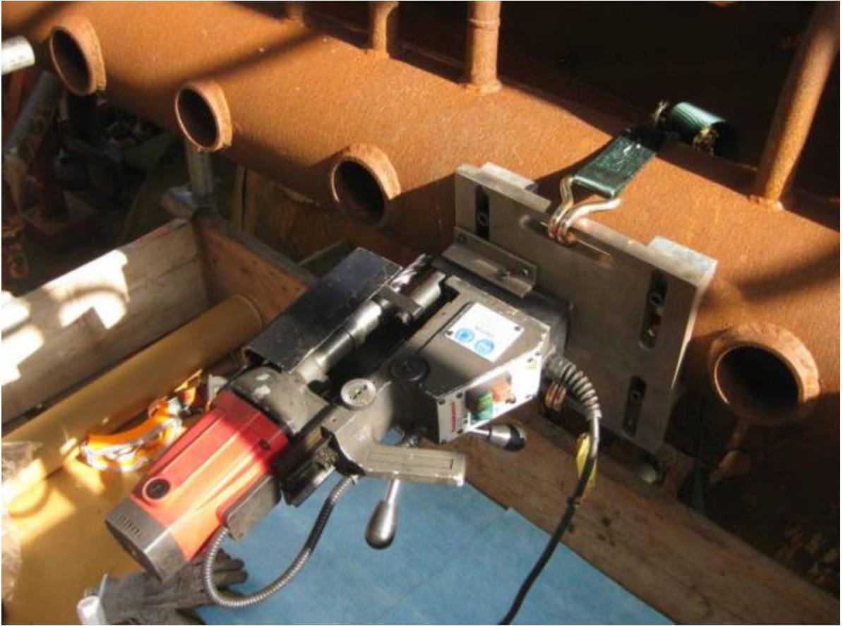
圖 4.16 使用以底盤來架設的電磁鑽頭
