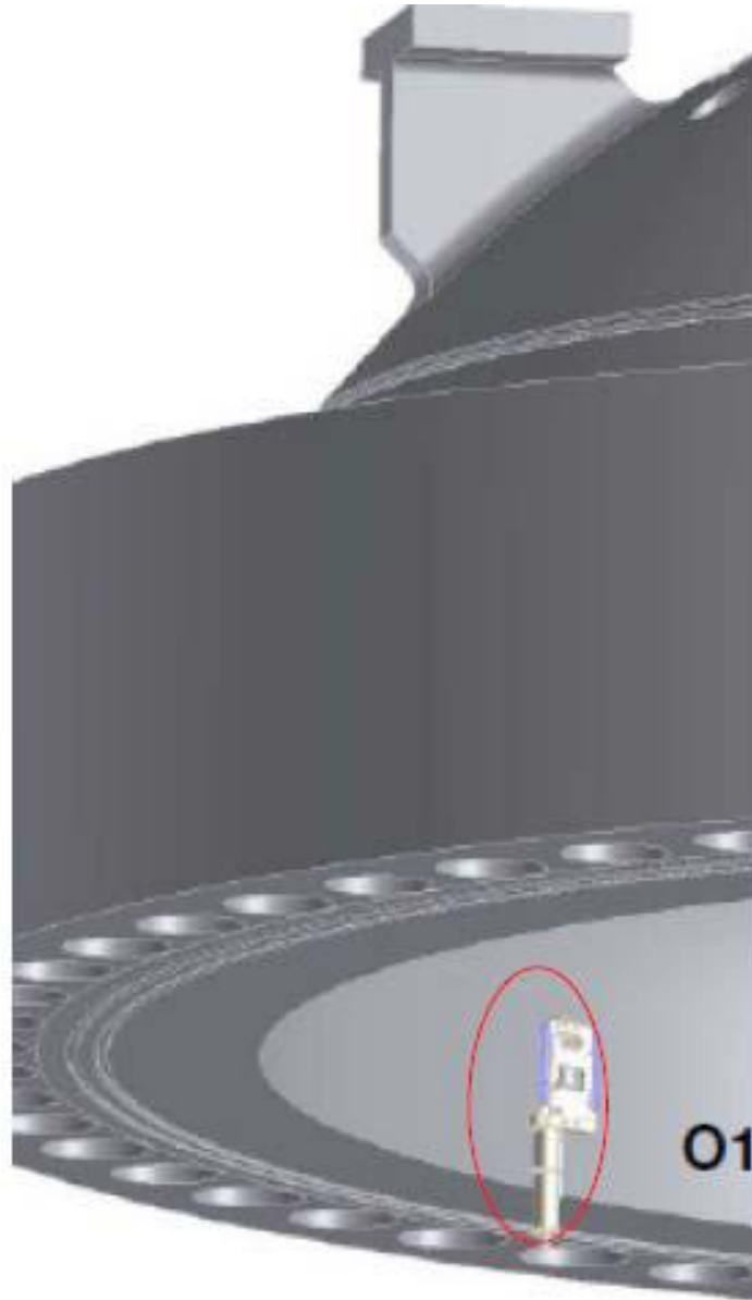
圖 4.4 取樣機器裝置於 RPV 頂端
