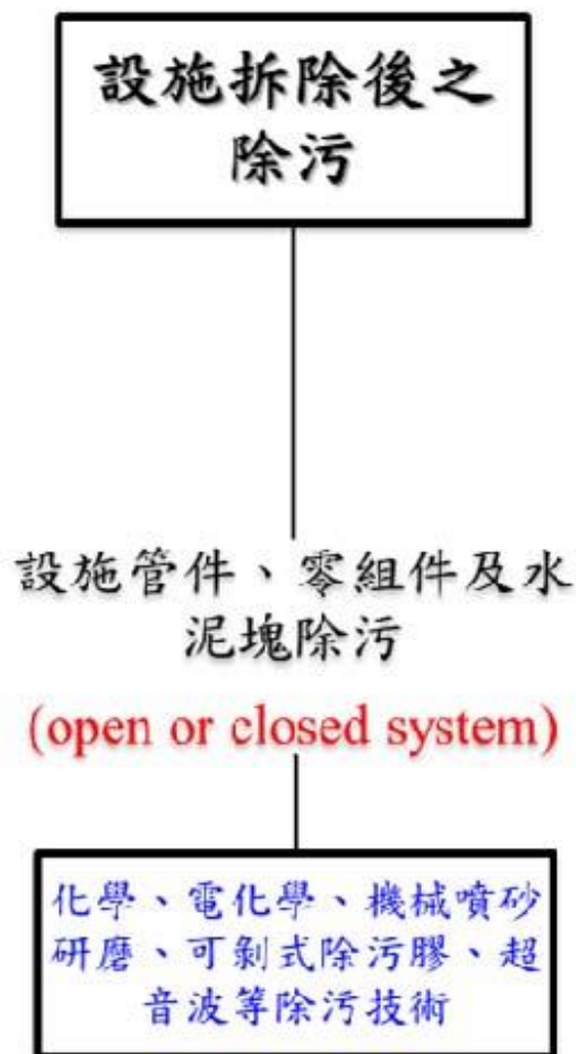
圖 4.6 核電廠除役設施拆除後之除污的處置簡圖
