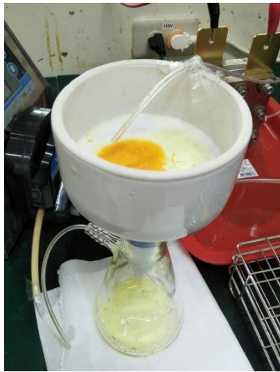
圖 2-11 實驗裝置圖(a) V_2O_5 過濾電解裝置圖 (b) V_2O_5 過濾裝置(c) V_2O_5 溶液經電解過程
