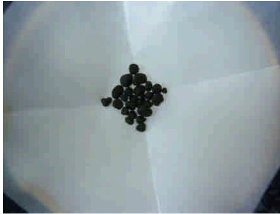
圖 20 實驗室合成之高純度高鐵酸鉀(NF6A3030C)
