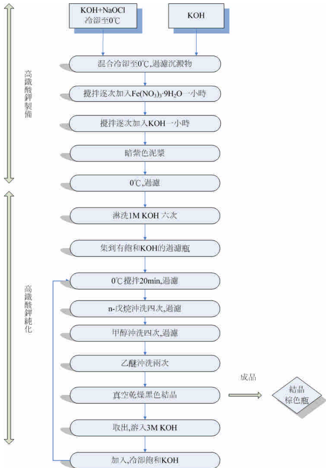
圖 22 高鐵酸鉀濕式氧化合成法流程圖(KOH)
