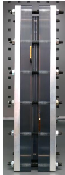
圖 17：(a)半單電池結構爆炸圖，其石墨板為可替換型式；(b)電池本體側視圖；(c)電池本體正視圖。
