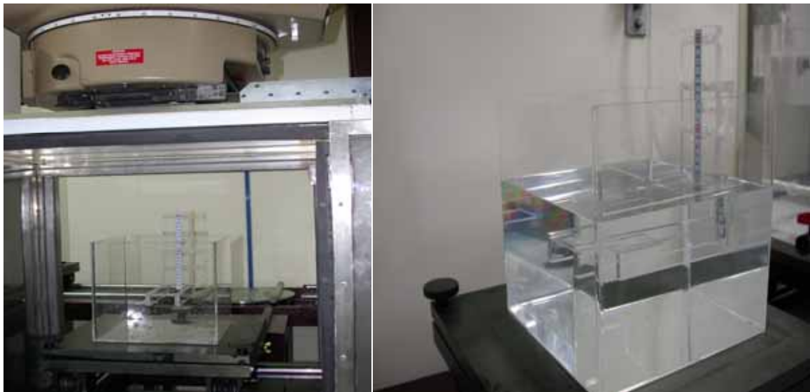
圖 11、TLD 在水假體中以 ^{60}\text{Co} 標準射源校正之情形
