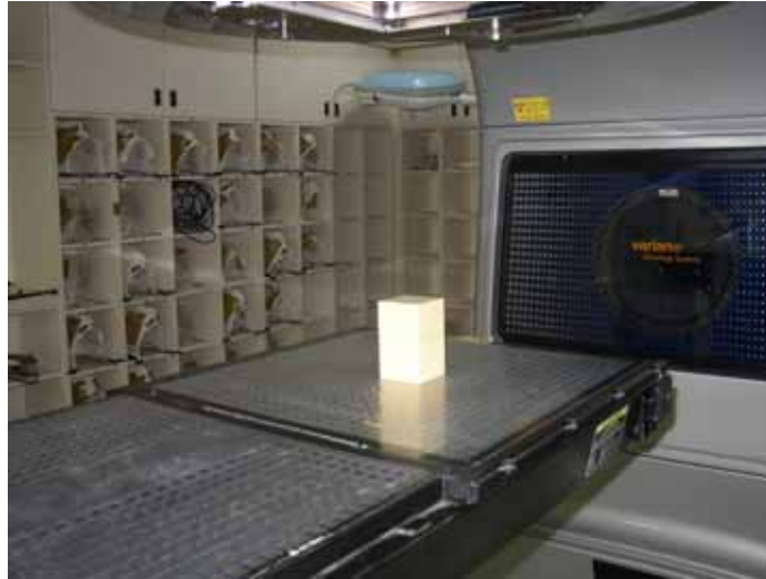
圖 13、TLD 在固態假體內以直線加速器照射之情形
