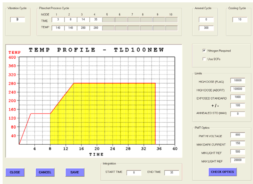
圖 1、LiF TLD-100 型熱發光劑量計讀取程序
