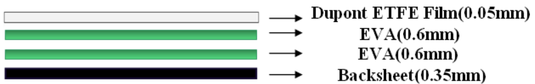
圖三、封裝測試片疊層
