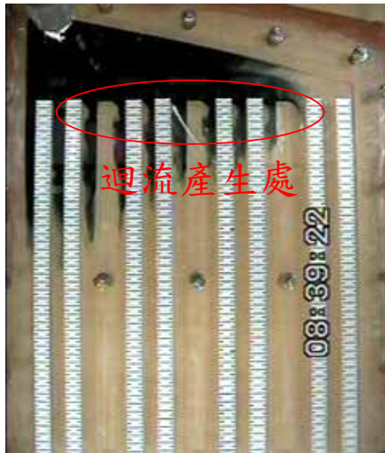
圖3.4、在Case A雙極板發生短暫迴流現象示意圖。左圖為圖10(6)放大的影像；右圖中長方形為Ribs。
