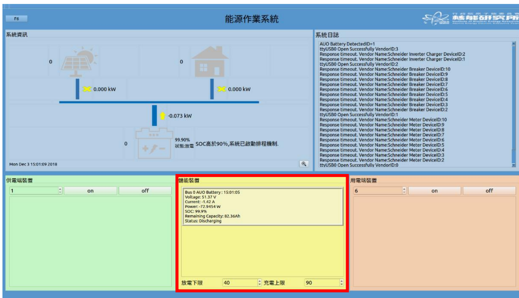
圖 2-3-5 EOS 全黑啟動及建立 Bus 0 設備的連結(友達儲能系統)
