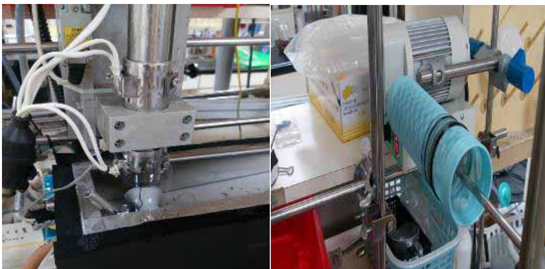
圖 15 濕式抽絲機與捲取實驗機
