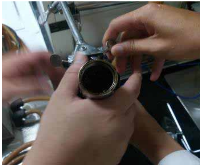
圖 17 紡絲液固定於擠出機上方
